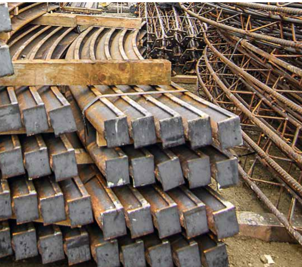
Werksfoto DSI Underground – PANTEX-Gitterträger
